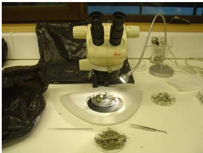
FIG. 20 – Preparação do Material Proveniente da Localidade de Referência da Serra do Cercal Para Determinação da Concentração Inicial em Elementos e Benzo(a)pireno
